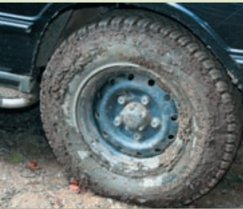
Gutes Geländeprofil: Die mit Schlamm gefüllten Reifen (Lamellen) lassen sich rasch entleeren und sind flugs für weitere Einsätze bereit.
